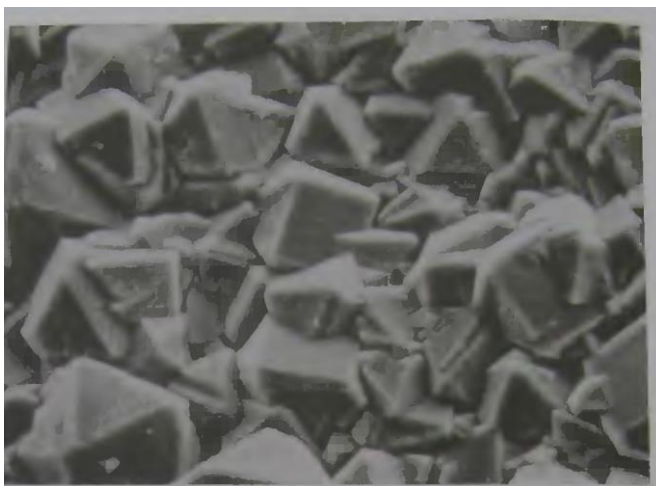
3.3-расм Олмос пленкаси сиртининг сканер қилувчи электрон микрофотографияси
