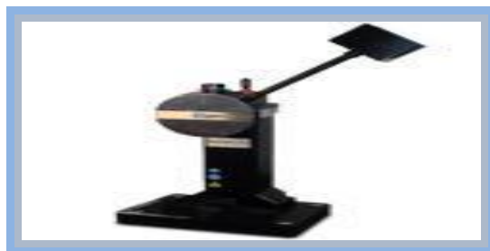
2.1-расм. Маятникли копёр” материалларни зарбий қовушоқлигини аниқлашда ишлатиладиган қурилма
