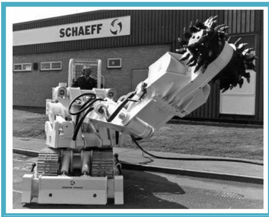
Рисунок 1.8. Наклон стрелы проходческого комбайна.
