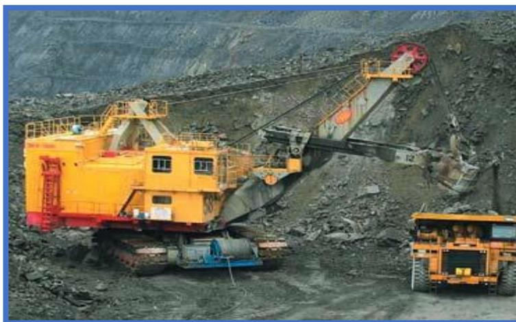
Рис.9. Экскаваторы типа прямая лопата с речным напором: а -ЭКГ-12 на разрезе Черниговский; б - ЭКГ-18 на Краснобродском разрезе УК «Кузбассразрезуголь»
