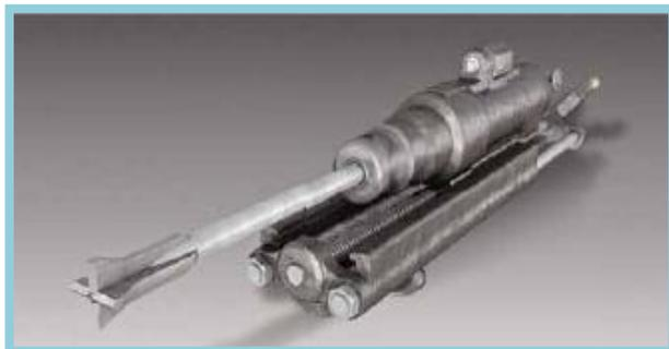
Рис-3. Первый пневматический перфоратор № 16 сделанном Атласом
