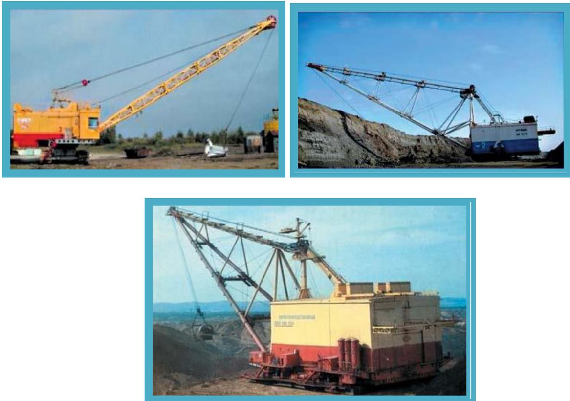
Рис. 11. Экскаваторы-драглайны производства УЗТМ: а - гусеничный драглайн ЭДГ-3,2.30; б - шагающий ЭШ 11.75; в - шагающий ЭШ 100.100
