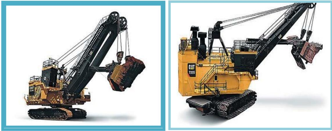
Рис. 4. Карьерные прямые механические лопаты Cat 7295; Cat 7395
