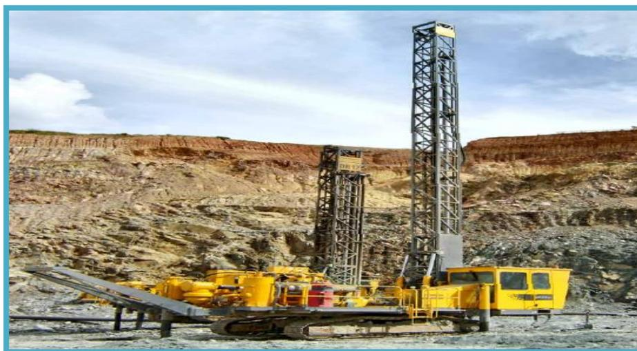
Рис-10. Буровой станок типа DM25-SP
