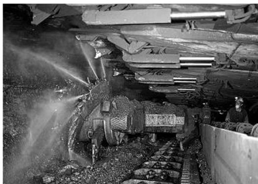
Рисунок 3.3. Общий вид шнекового рабочего органа в забое.
