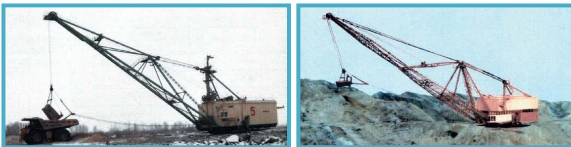
Рис. 12 Шагающие драглайны НКМЗ: а - ЭШ- 6,5/45 при погрузке в автотранспорт; б - ЭШ-15/80 – забое бестранспортной системы разработки
