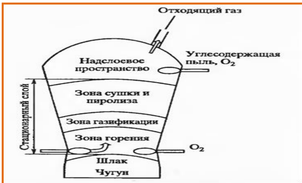
Рис. 4.2. Схема рабочего пространства реактора газификатора COREX
