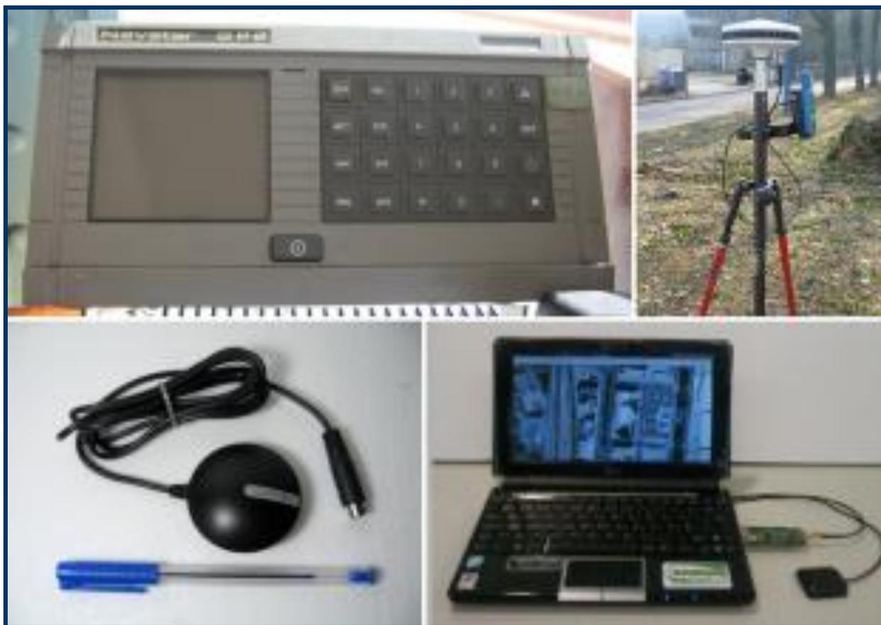
Рис.2. Различные GNSS приемника платформы: Морской (верхний левый), Survey (вверху справа), автомобильная промышленность (снизу войлок), Программное обеспечение (внизу справа).
