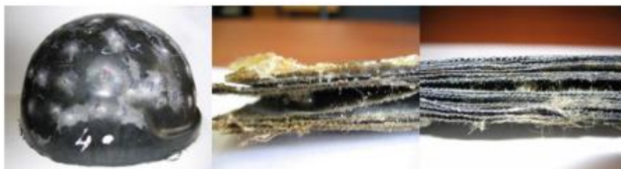
Расм 1.11. Кевлар-29 арамид толаси асосидаги композицион маҳсулотлар. 13
