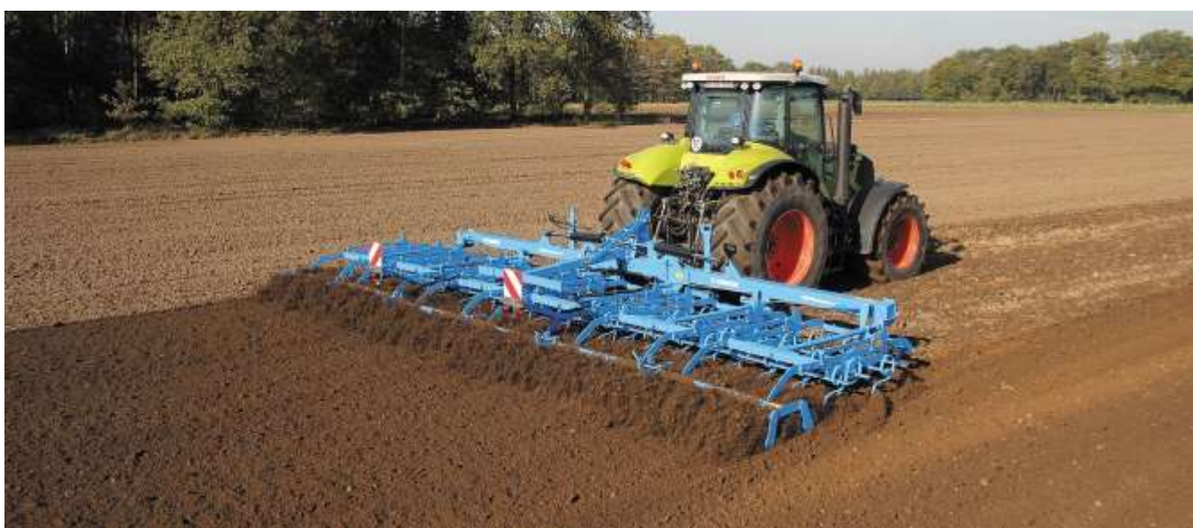
3-расм. Чизел ва бороналашнинг бир вақтда амалга оширилиши жараёни
