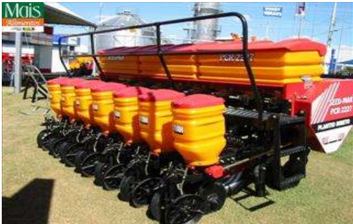
6-расм. Ерга ишлов бермасдан тўғридан-тўғри донли экинлар уругини экувчи универсал “Vence tudo” русумидаги 4 ва 8 қаторли, иш унумдорлиги юқори бўлган Бразилия сеялкалари
