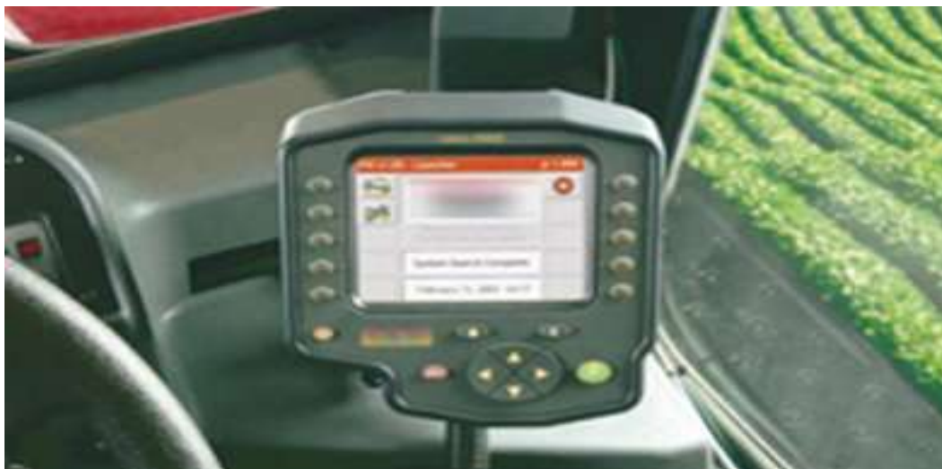
40-расм. Тракторга ўрнатилган ГИС технологияси асбоби
