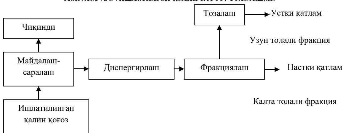
14-расм. Икки қатламли қалин қоғоз ишлаб чиқаришда фойдаланилган қалин қоғоздан диспергирлаш ва фракциялаш босқичлари киритилган макулатура толасини тайёрлашнинг технологик схемаси
