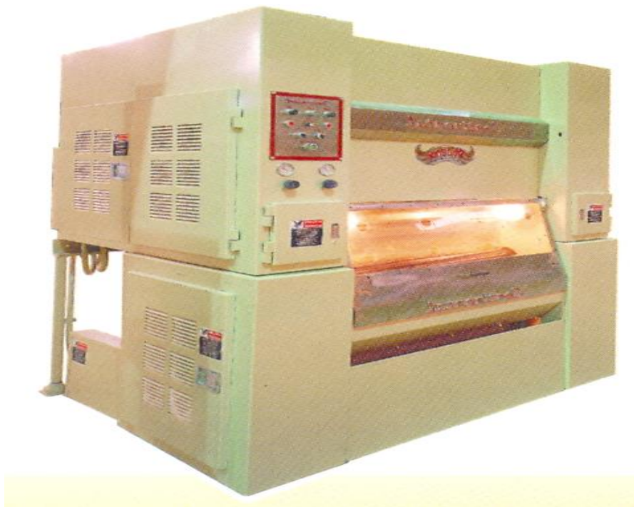
1.27-расм. “Фенникс Ротобар” валикли жинининг ташқи кўриниши. 1.Тозалагич- таъминлагич; 2.Валикли жин.
