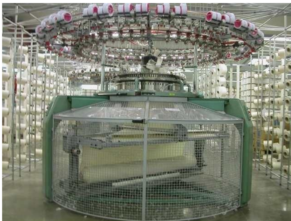
3.5-расм. Икки игнадонли жаккард трикотажа машинаси Mayer & Cil (Германия).
