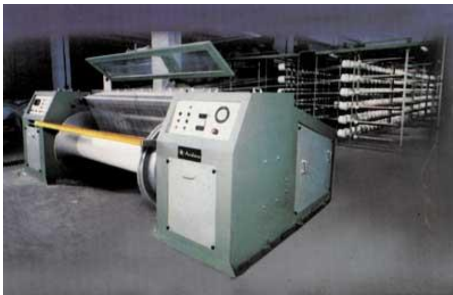
2.4.-расм Гуруҳлаб тандалаш машинаси
