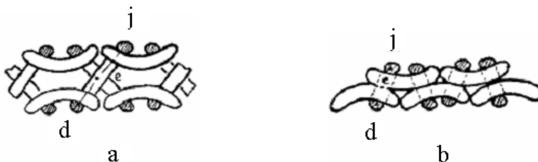
3.6 -расм. Интерлок ва ластик тўқималарининг кўндаланг кесимлари
