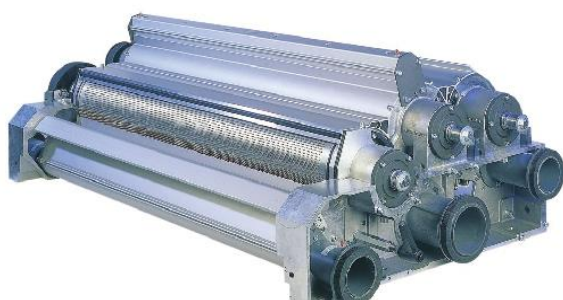
1.12-расм. Webfeed- дастлабки тараш қурилмаси
