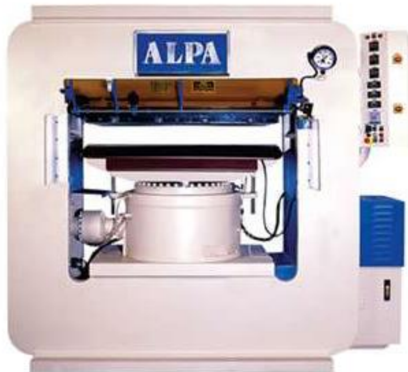
4.9-расм. 850 тоннали дазмоловчи меря босувчи пресс
