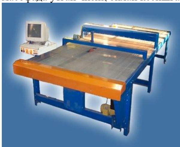
4.11-расм. Чарм майдонини ўлчовчи ИВА-1800 машинаси
