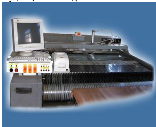
4.12-расм. Чарм майдонини ўлчовчи ИВА-3360 машинаси
