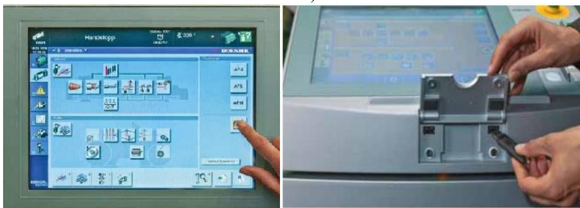
2.2-расм. Сомет а) ва Dornier б) тўқув дастгохларини электрон назорат панели*
