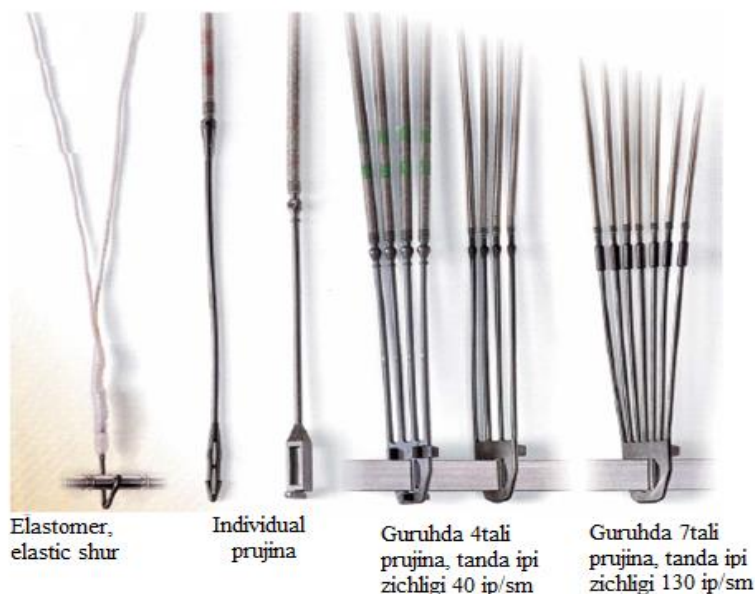
2.19-расм. Танда ипларини пастга тушириш элементлари
