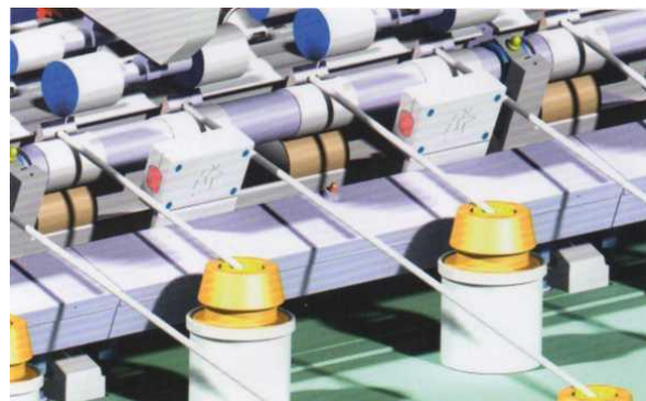
1.12-расм. Пилик назоратчиси ўрнатилиши
