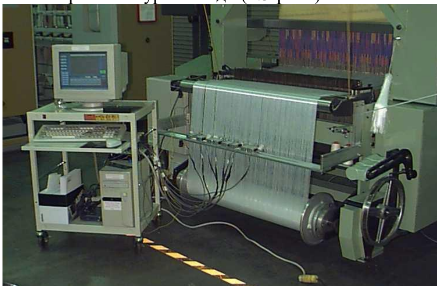
2.3-расм. Тензометрик усулда танда ипини назорат қилиш
