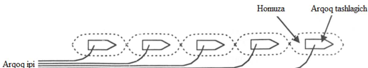
2.27-расм. Арқоқ йўналишида кўп хомузани ҳосил қилиш
