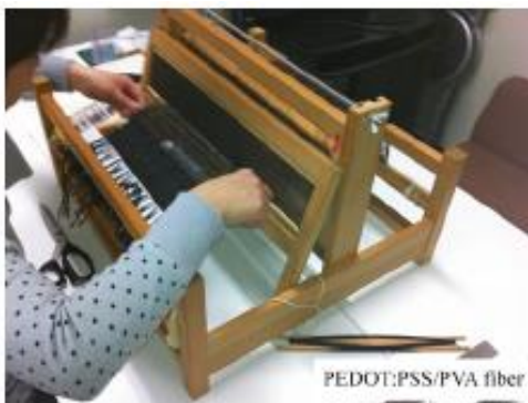
4.6-расм. PEDOT: PSS/PVA аралашган толалари асосидаги тўқимачилик электродларини тайёрлаш учун мўлжалланган тўқувчилик дастгоҳининг фотосурати 1
