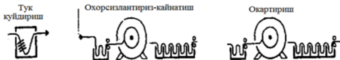
3.4-расм. Охорсизлантириш-қайнатиш жараёнлари биргаликда олиб бориладиган ярим узлуксиз пардозлашга тайёрлаш схемаси
