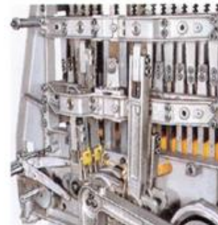
2.10-расм Штоубли жаккард машинасини кўриниши
