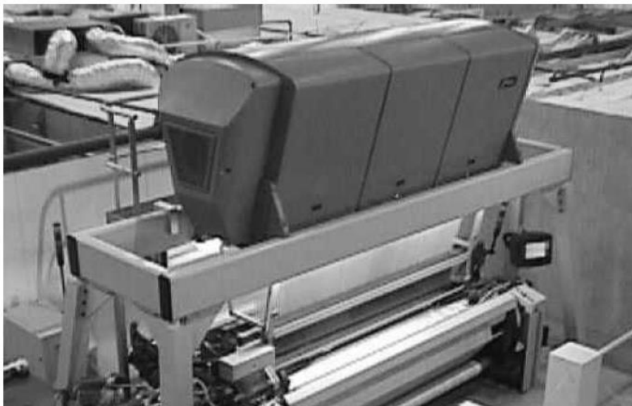
2.8-расм. Staubli INIVAL 100 жаккард машинаси
