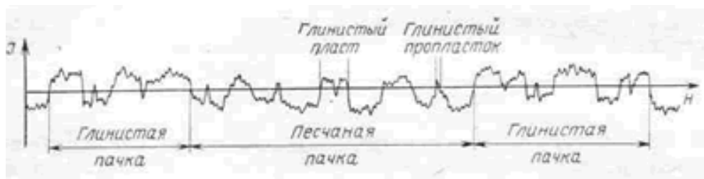
2.3.Рис. . Расчленение кривой ГК с помощью алгоритма КЧП
