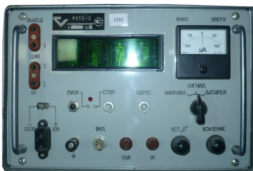
2.25- расм. РЭТС-2 расходомерия ўлчовларини ер усти бошқариши
