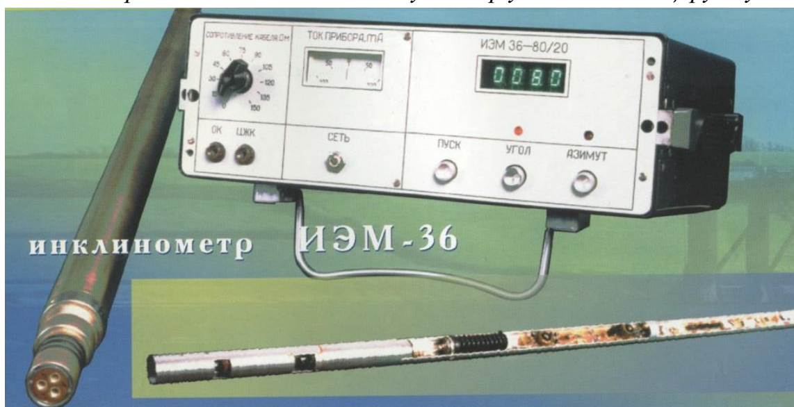
2.4 - расм. ИЭМ-36 асбоби ва унинг ер устидаги бошқарув пулти
