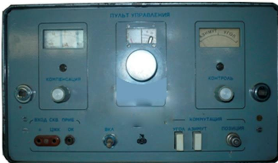
2.1-расм. КИТ - 60 қудуқ зонди ва КИТ-60 асбоби ва унинг ер устидаги бошқарув пулти
