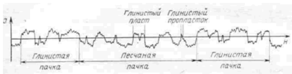
Рис. . Расчленение кривой ГК с помощью алгоритма КЧП
