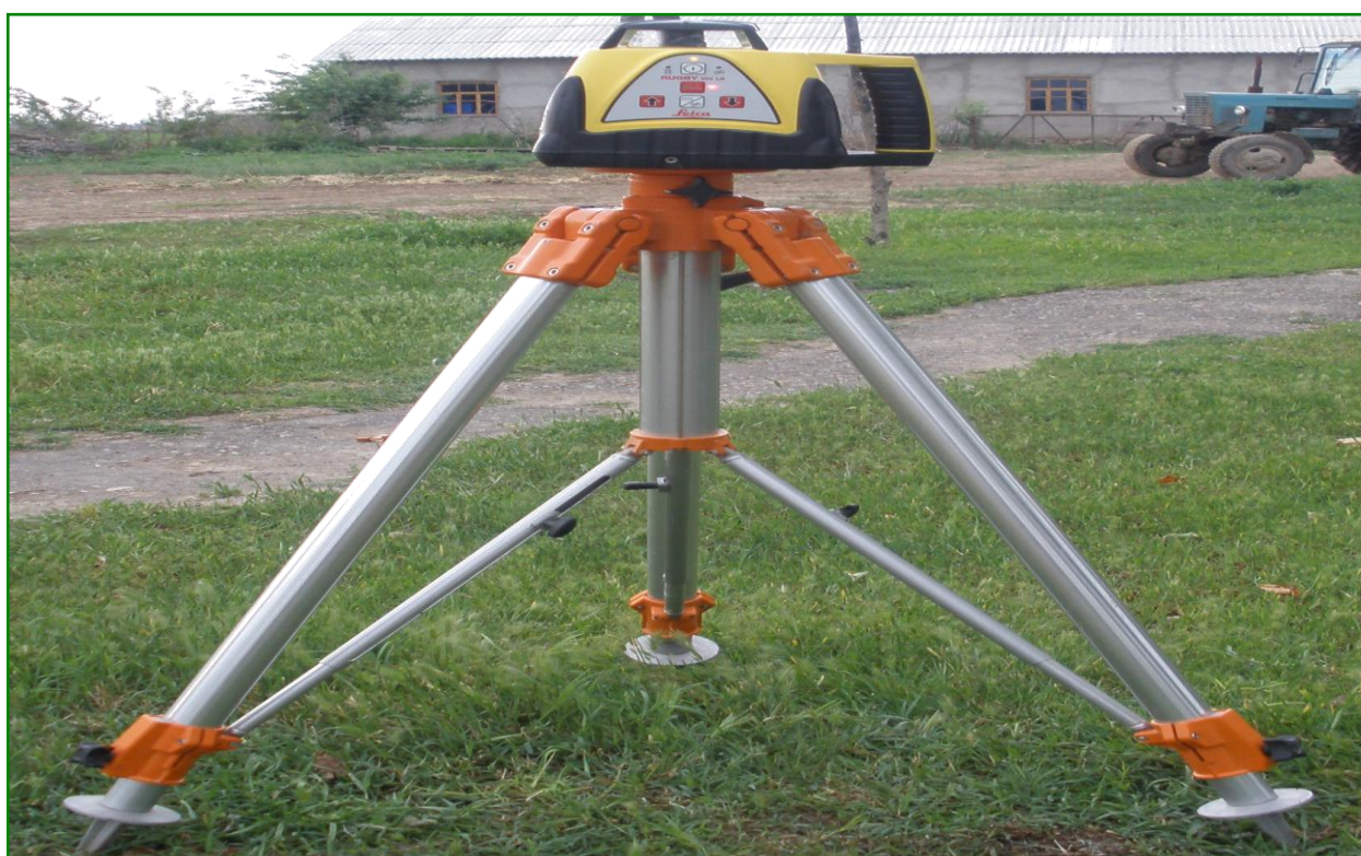
14-расм. Ерни текислашда ишлатиладиган янги лазер мослама «Rugby 100LR»
