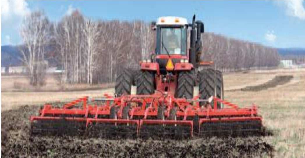
1-расм. Дискли борона («Diskomaster»)»
