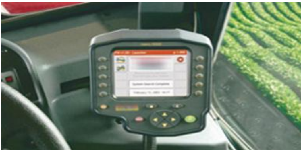
40-расм. Тракторга ўрнатилган ГИС технологияси асбоби
