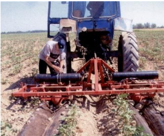
22а-расм Ғўзани эгатга тўшалган плёнкалар орқали суғориш учун эгатга қора плёнкалар тўшаш.
