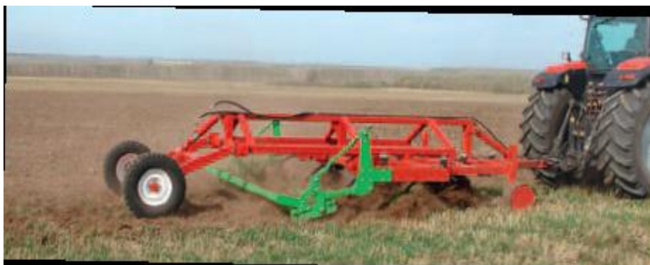
4-расм. Чизелли плуг («CHIZELMASTER»)
