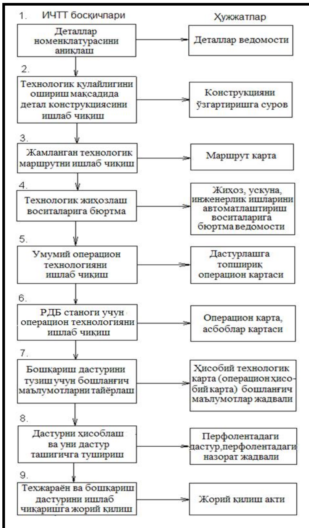
Расм - 1. РДБ станогидан фойдаланишда ИЧТТ блок-схемаси
