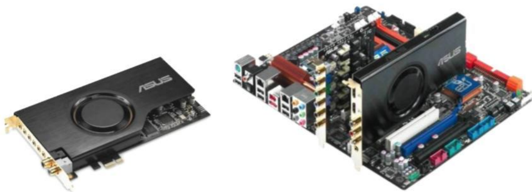
2-расм. Аудио адаптер ва унинг бош платага уланиши
