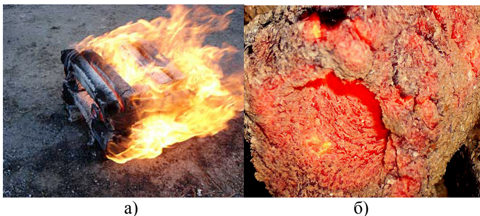
9.9-расм. Брикетларнинг алангаланиб (а) ва чўғланиб (б) ёниш жараёни.
