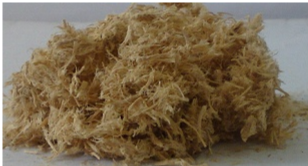
11-расм. Иккинчи босқичдан кейин олинган ярим тайёр целлюлоза намунасининг умумий кўриниши.
