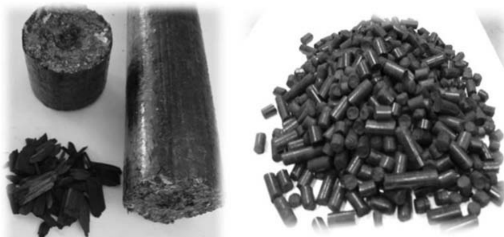
9.14-расм. Куйдирилган ёғоч, унинг зичланган брикетлари (чапда) ва пеллетлари (ўнгда).
