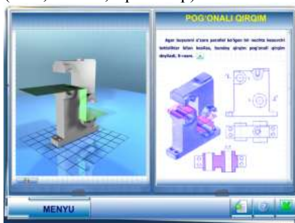
2.11-расм. Поғонали қирқимни ҳосил қилиш учун деталнинг текислик билан хаёлан кесилиши анимацияси
