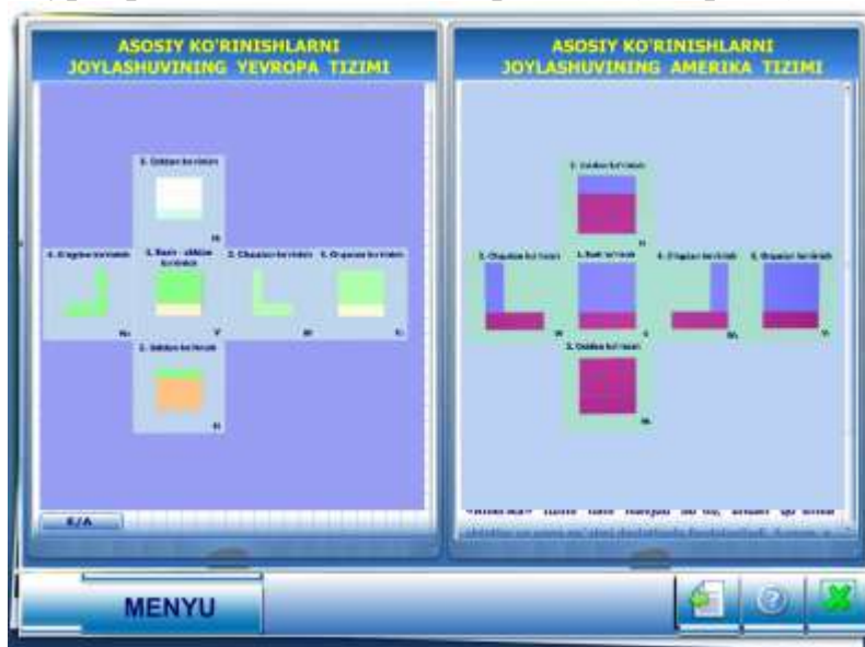
2.7-расм. Кўринишларнинг Европа ва Америка тизимини солиштириш
