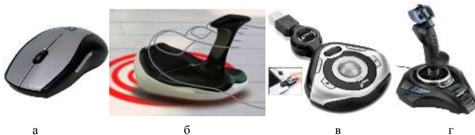
4-расм. а) сичқонча, б) оёқ манипулятори, в) шарикли манипулятор (трекбол), г) джойстик
