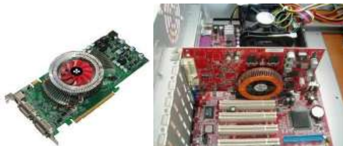
3-расм. Видео адаптер ва унинг бош платага уланиши
