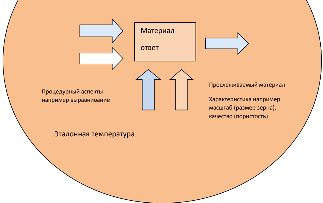
Кольцо уверенности рис. 1.4 для материальной собственности объединило измерение, и проверяющий - отмечают, что отдельные требования отслеживаемости относятся к прикладному стимулу (груз), ответ (смещение) и существенная характеристика (размер зерна, пористость)
