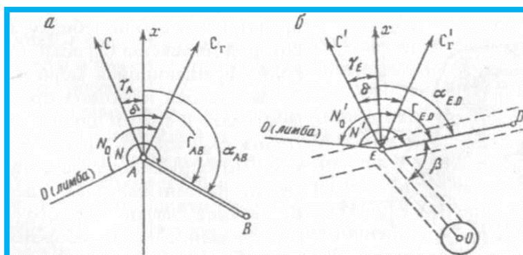
Рис. 10.6. Схема гироскопического ориентирования на земной поверхности (а) и в шахте (б)
