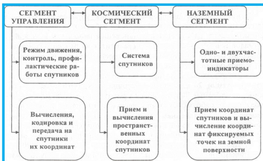
Блок-схема работы GPS
