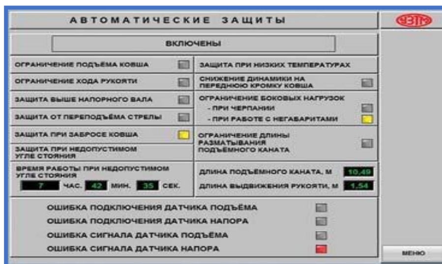
Рис.10 Экраны информационной системы экскаватора ЭКГ-12А: а – главный; б - автоматических защит рабочего оборудования
