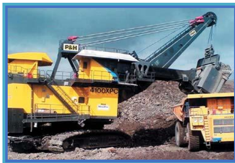
Рис. 6. Самая мощная модель карьерной механической лопаты с реечным напором 4100ХРС компании P&H (а)
