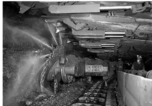
Рисунок 3.3. Общий вид шнекового рабочего органа в забое.
