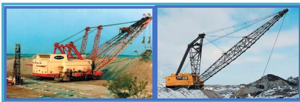
Рис. 13. Шагающие драглайны Caterpillar (Bucyrus): а - модель 4250-W; б - модель 8750
