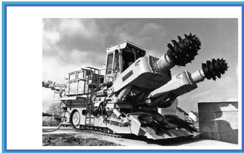
Рисунок 1.6. проходческая машина с двойной стрелой.
