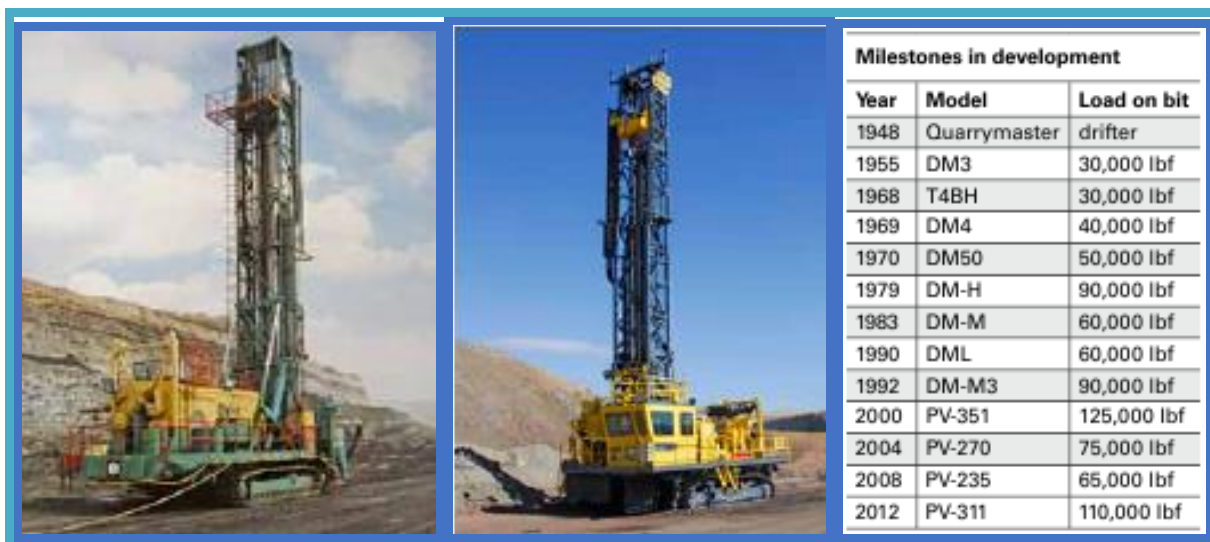
Рис-7. Станок DM-H, в 1979 г. выпуска, нагрузка на долота до 90,000 фунт-сил (400 кН).
