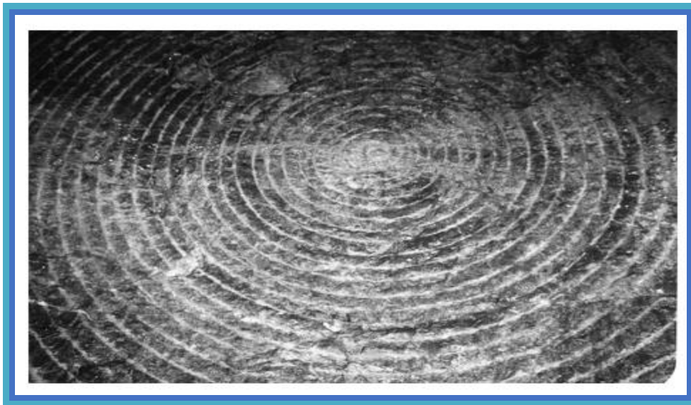
Рисунок 2.2. Вид забоя при проходке дисковыми резцами.
