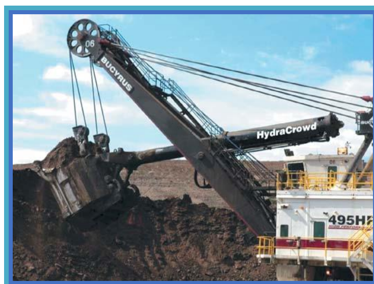
Рис. 2. Карьерная механическая лопата 495HF компании Сатерpillar с гидравлическим напорным механизмом «HydraCrowd»
