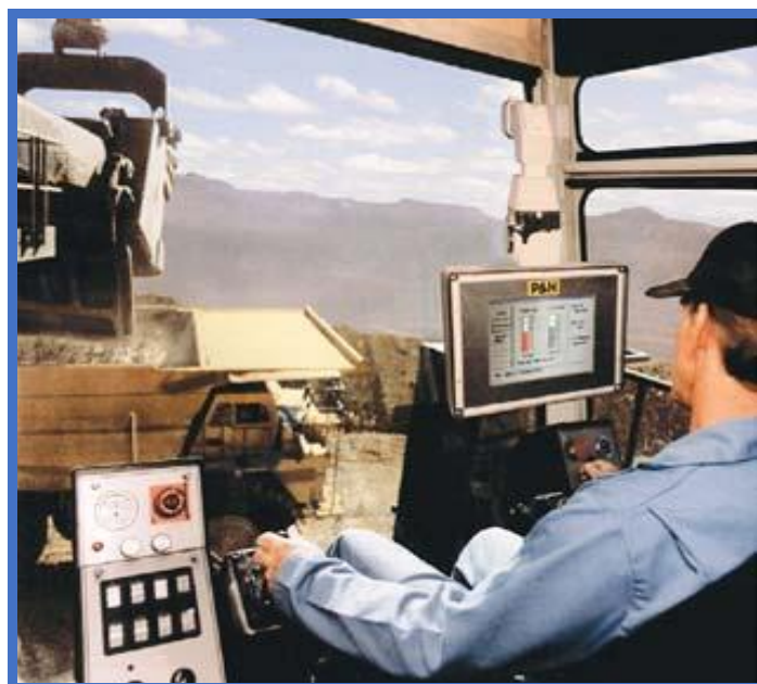
Рис. 7. Кабина машиниста экскаватора Р&Н с графическим интерфейсом управления (б)
