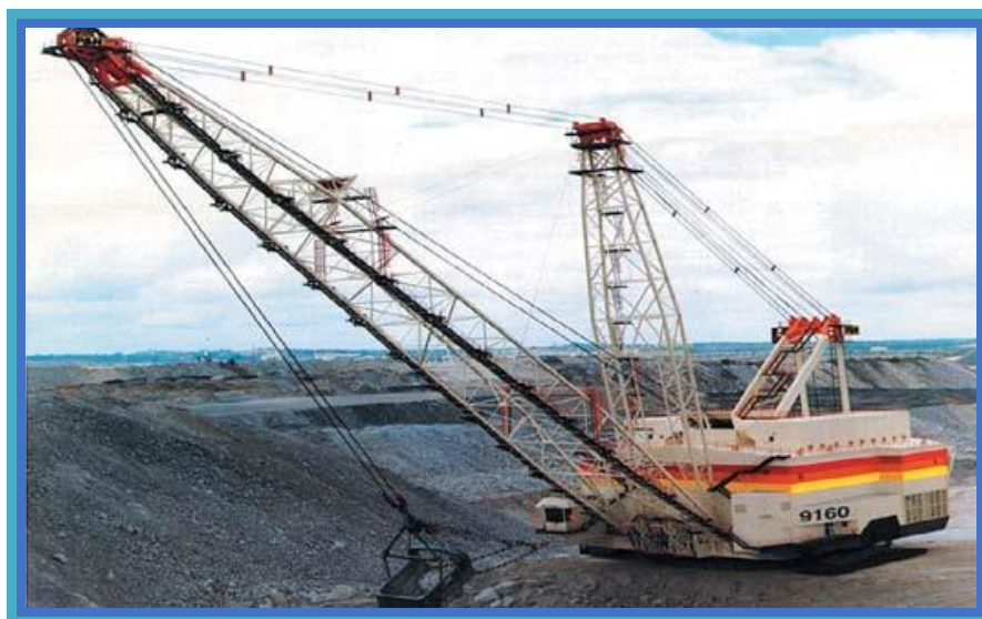
Рис. 15. Шагающий драглайн модель 9160 компании Surface Mining (P&H)
