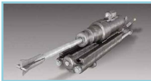
Рис-3. Первый пневматический перфоратор № 16 сделанном Атласом
