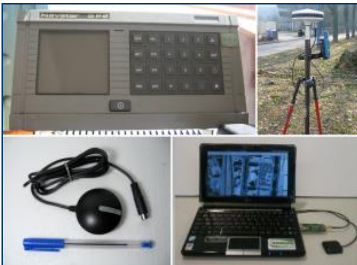
Рис.2. Различные GNSS приемника платформы: Морской (верхний левый), Survey (вверху справа), автомобильная промышленность (снизу войлок), Программное обеспечение (внизу справа).
