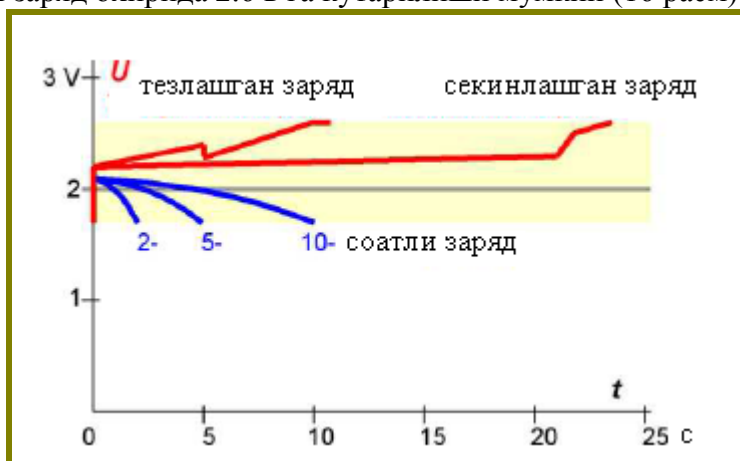
Рис. 5.16. Қўрғошинли аккумуляторни кучланишини турли заряд ва разрядда ўлчаш.
