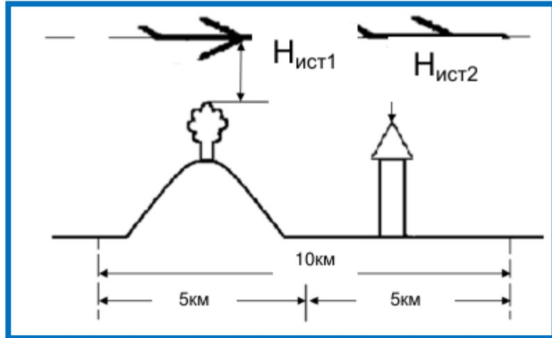
Рис. 2. Определение истиной высоты полета
