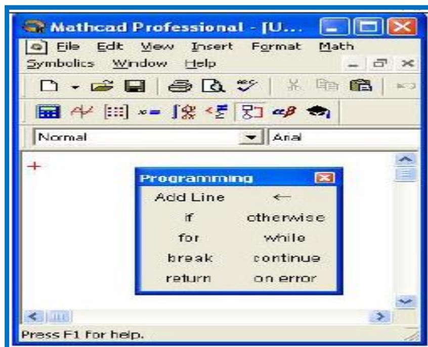
Рис. 2. Вид панели инструментов Programming (Программирование)
