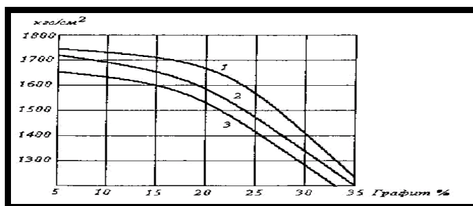
6.3-расм. Графит кукун миқдори ва пресслаш босимининг углерод-графит материалнинг сиқилишдаги мустаҳкамлигига таъсири: пресслаш босими 1 - 7 т/см 2 ., 2 - 6 т/см 2 , 3 - 5 т/см 2 .
