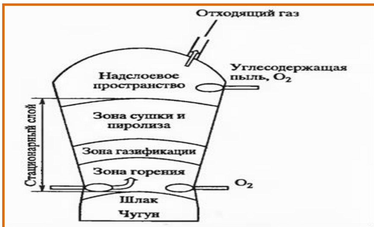
Рис. 4.2. Схема рабочего пространства реактора газификатора COREX
