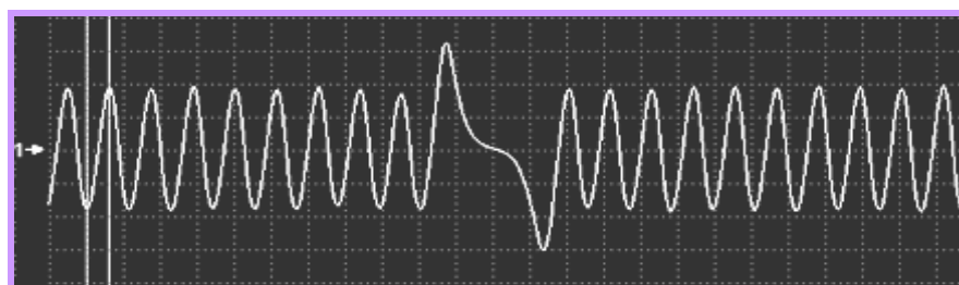
Рис. 3.5 Синусоидальный выходной сигнал датчика положения коленчатого вала
