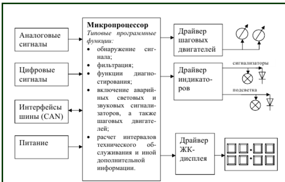
Рисунок 5.3- Блок-схема электронной приборной панели с применением микропроцессора
