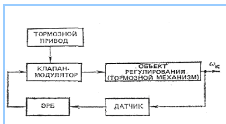
Рис. 4.2 Функциональная схема АБС
