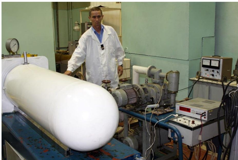
Расм 1. ЎзФА ЯФИ даги НГ-150 нейтрон генератори
