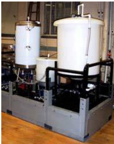
4.10-расм. Тажриба (чапда) ва саноат (ўнгда) биореакторлари
