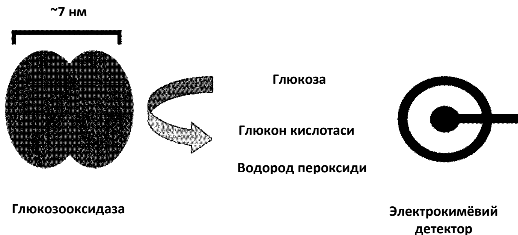
1.1-расм. Ферментатив реакция ва электрокимёвий детектор ҳамкорлигида қон таркибидаги глюкозани аниқлаш. Глюкозани глюкозооксидаза билан оксидлаганда, водород пероксиди ҳосил бўлади ва уни концентрациясини электрокимёвий детектор ёрдамида аниқланади. Бундай сенсорни фермент молекуласини ўлчамигача (<10 нм) кичиклаштириши мумкин
