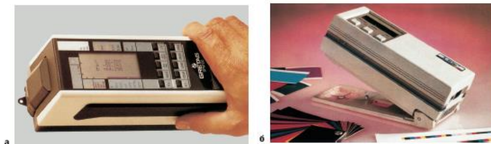
8-Рисм. Рангларини ўлчаовчи асбоблар: а спектрофотометр СПМ 100 (Гретаг); б спектроденситометр 938 (X-Rite)
