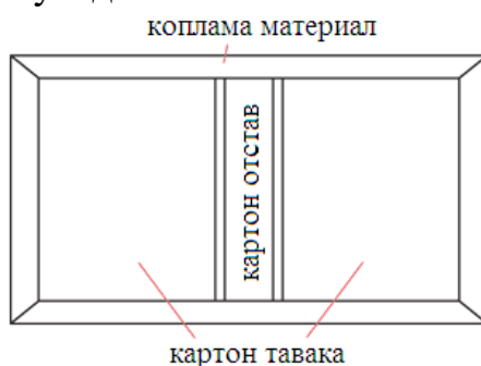
Расм 1. Стандарт китоб муқовасининг тузилиши
