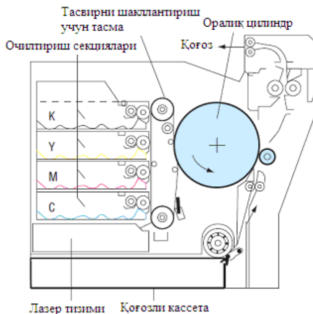
Расм 11. Кўп бўёкли босма учун бир нечта прогонли тизим, тасвир ташувчиси сифатида фоторецептор билан қопланган тасма мавжуд, бир бўёкли тасвирларни йиғиш ва бир-бирига мослаштириш оралик цилиндрда амалга оширилади (BeamStar, itachi)
