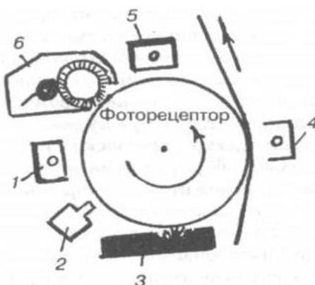
3-расм. Heikon DCP 320D машинасининг босиш секцияси схемаси: I — заряд коротрони; 2 — ёруғлик диодли линейка; 3 — очилтириш қурилмаси; 4 — ўтказиш коротрони; 5 — дастлабки зарядлаш қурилмаси; 6 — фоторецепторни тозалаш қурилмаси. Қоғоз полотносининг ҳаракатланиши стрелка билан кўрсатилган
