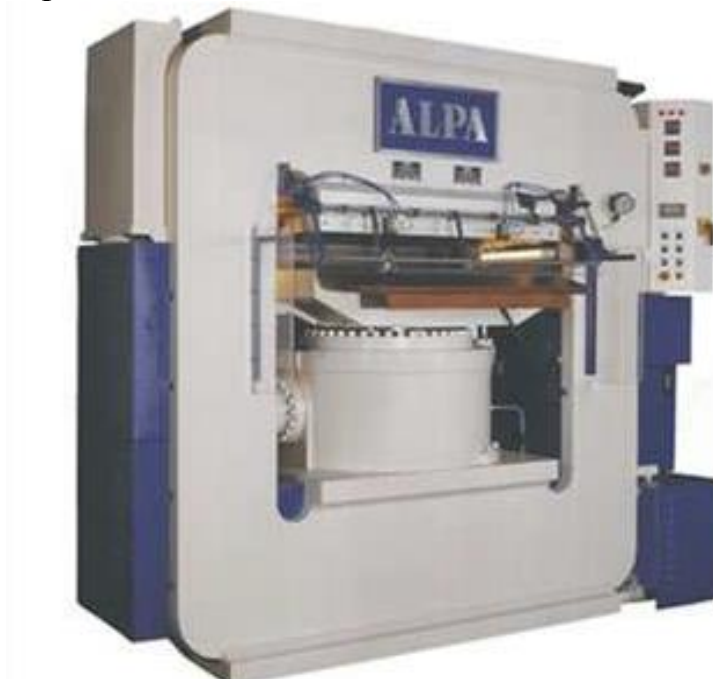
4.8-расм. 1150 тоннали дазмолловчи меря босувчи пресс
