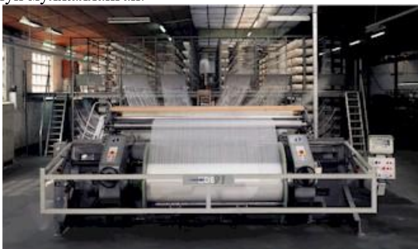
2.5.-расм SDB91-300 русумли гуруҳлаб тандалаш машинаси
