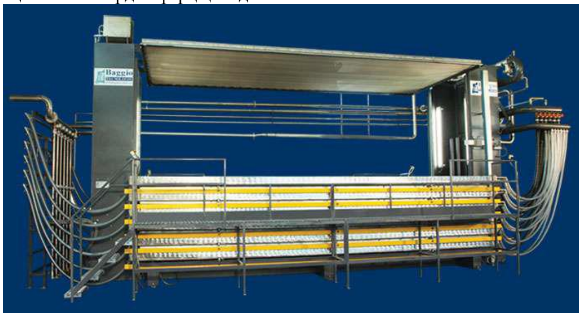
4.5-расм. “TIARA ERGOVAC” паст температурали вакуумли қуритиш машинаси
