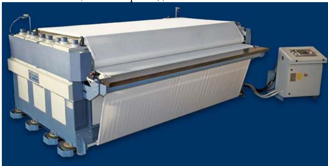
4.3-расм. NEW FUTURA серияли тортиб- юмшатувчи PALISSONATRICI машинаси (Италия)
