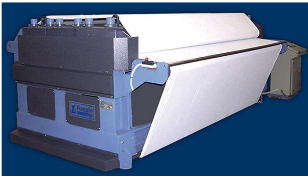
4.4-расм. Бўяшдан сўнг ва Вет-блю чармлари учун тортувчи машина 4.3.Қуритиш машиналари
