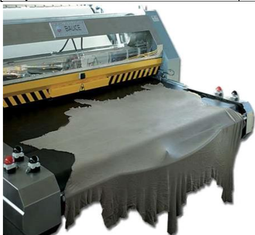
4.1-расм “STENPRESS MVC-4 Versus” гидравлик ўтувчи сиқувчи ёювчи машинасининг ташқи кўриниши
