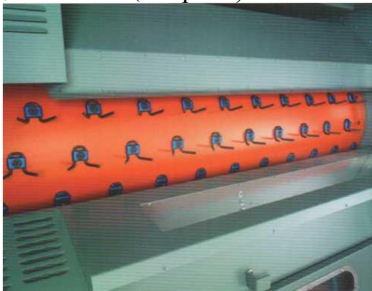
1.4-расм. Штифтлар жойлашуви 1.5-расм. Колосниклар ўрнатилиши
