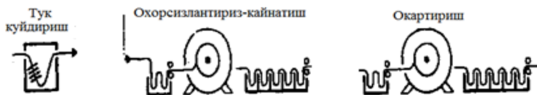
3.4-расм. Охорсизлантириш-қайнатиш жараёнлари биргаликда олиб бориладиган ярим узлуксиз пардозлашга тайёрлаш схемаси
