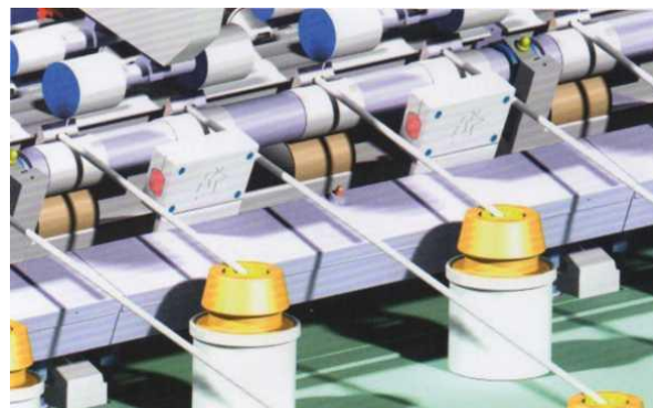
1.12-расм. Пилик назоратчиси ўрнатилиши
