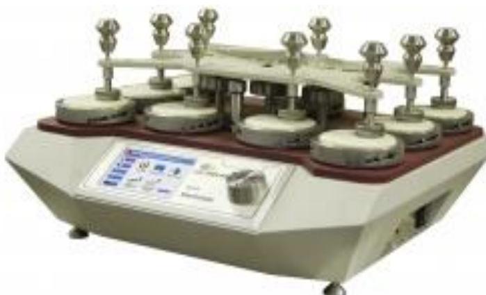
22-расм. Турли тузилишдаги матоларнинг ишқаланишга чидамлилигини аниқлаш асбоби.
