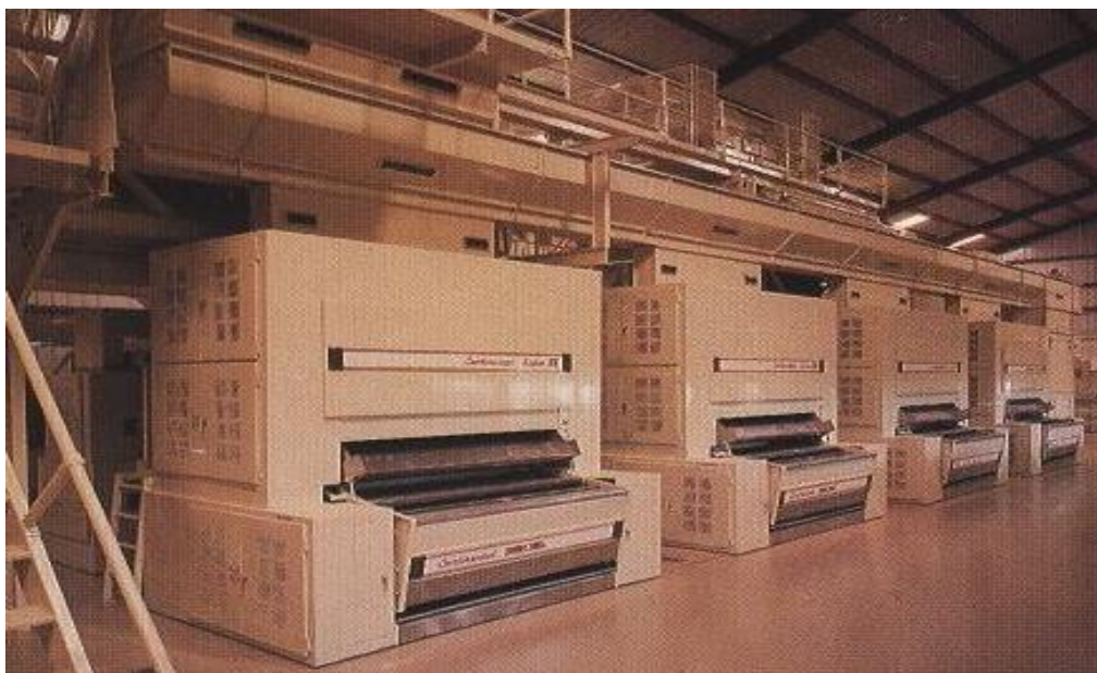
1.21-расм. Аррали жинлар ўрнатилган қаторнинг умумий кўриниши
