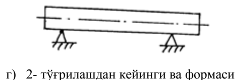
4.4-расм. Икки жараёнли тўғрилаш схемаси.
