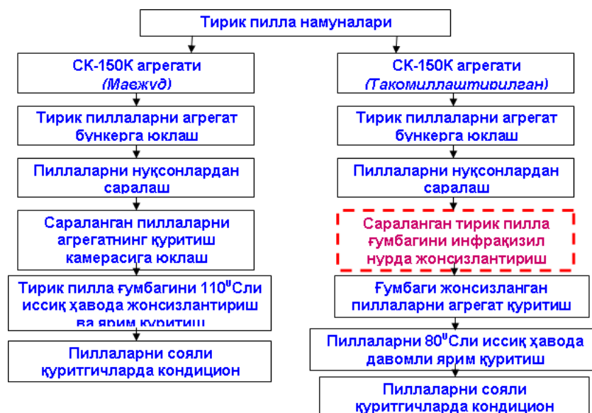
4.4-расм. СК-150К агрегатида тирик пиллаларга ишлов беришнинг мавжуд ва такомиллаштирилган технологик жараёнлари кетма-кетлиги
