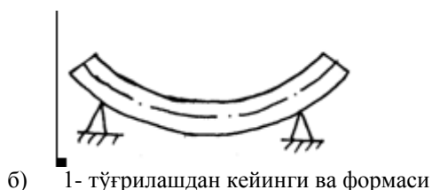
4.4-расм. Икки жараёнли тўғрилаш схемаси.
