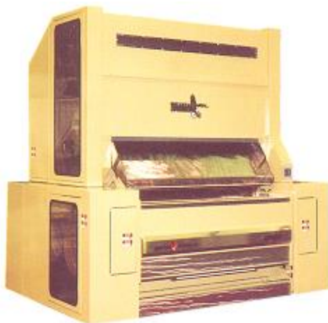
1.24-расм. Устига Extractor-Feeder Model-2000 ўрнатилган 161- аррали жиннинг умумий кўриниши
