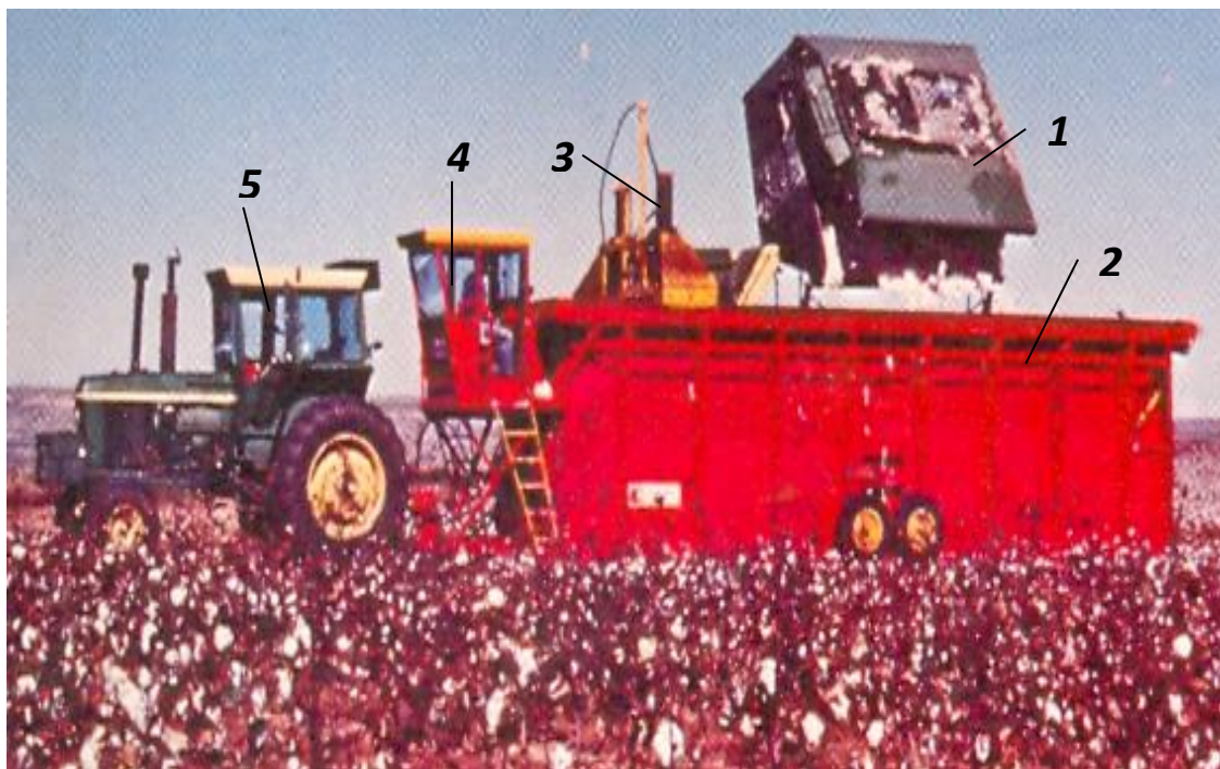
1.1-расм. Пахта териш комбайнидан чигитли пахтани модул тайёрлагичга юклаш жараёни
