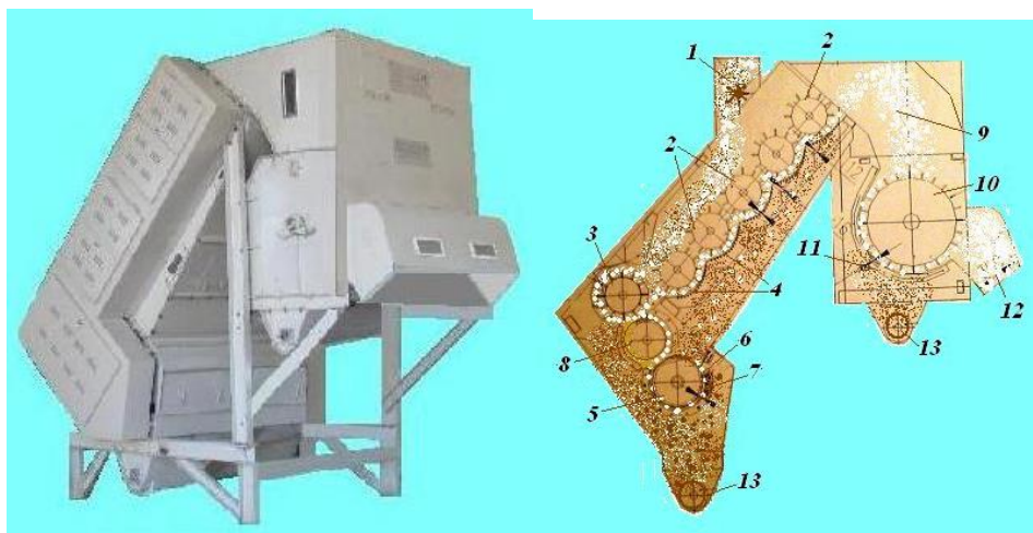
1.18-расм. МКЗК-2400 русумли пахта тозалагичининг қирқими.
