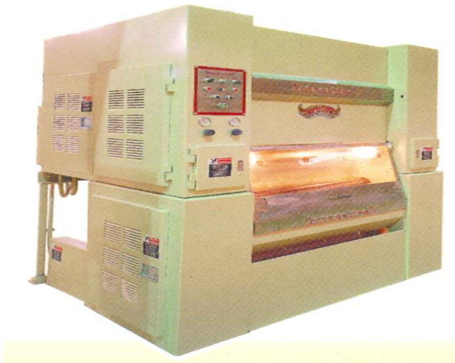
1.27-расм. “Фенникс Ротобар” валикли жинининг ташқи кўриниши. 1.Тозалагич- таъминлагич; 2.Валикли жин.
