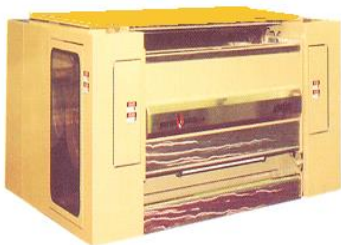
1.26-расм.161-аррали жиннинг ташқи кўриниши ва технологик схемаси.
