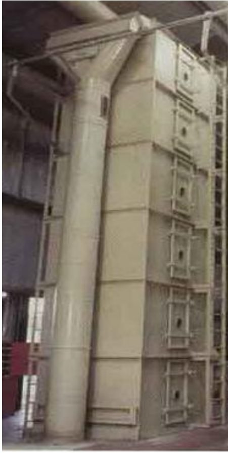
1.1-расм. Минорали қуритгични ташқи кўриниши ва технологик схемаси 1. Нам пахтани узатиш пневмоқувури; 2. Қуритгич қобиги; 3. Қуритишда пахта ўтадиган куракчалар; 4. Қуриган пахтани олиб чиқувчи қувури;
