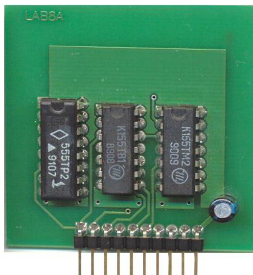
4.6 – расм. Триггерлар ишини тадқиқ этишда қўлланиладиган Lab8A модулининг ташқи кўриниши.
