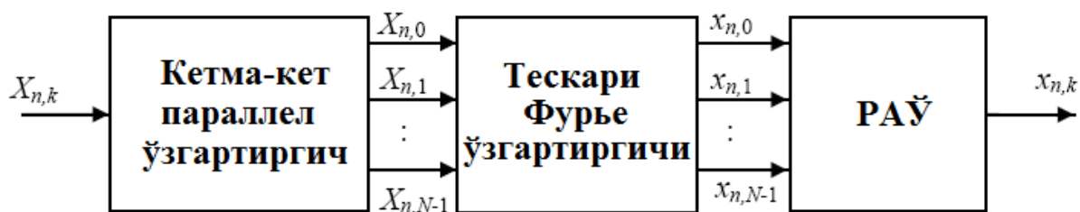
2.26-расм. OFDM сигналини ҳосил қилиш принципи.
