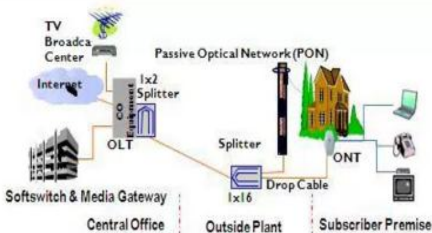
2.2-расм. Пассив Оптик тармоқнинг соддалаштирилган архитектураси.
