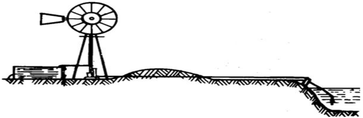
3.3-расм. Ер усти манбасидан сув кўтариб бераётган поршенли насосниҳаракатга келтирувчи шамол қурилмаси.
