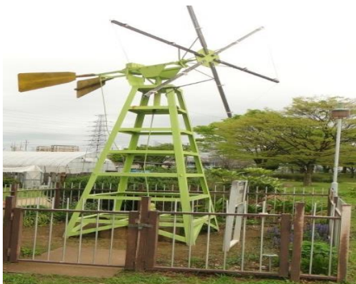
3.2 -расм. Ер ости қудуғидан сув кўтариб бераётган поршенли насосниҳаракатга келтирувчи шамол қурилмаси.
