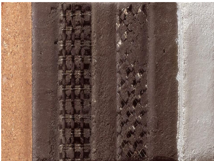
Икки сеткали углеводородтоладан арматураланган сувоқ қатлами таркиби
