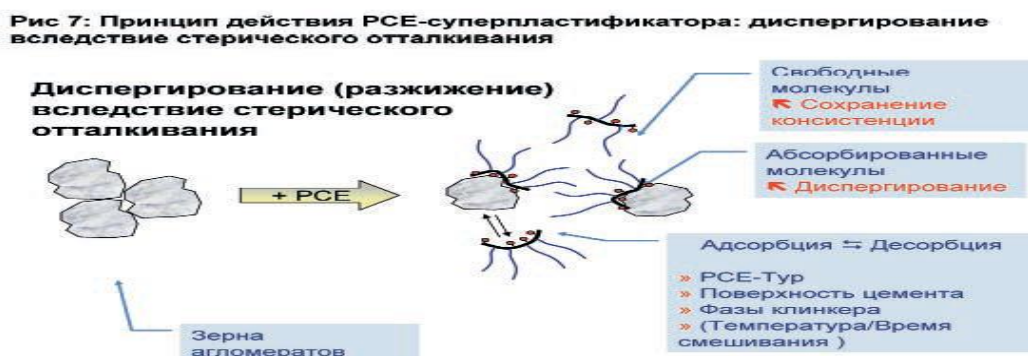
4.7-расм. GLENIUM суперпластификаторларнинг таъсир кўрсатиш механизми
