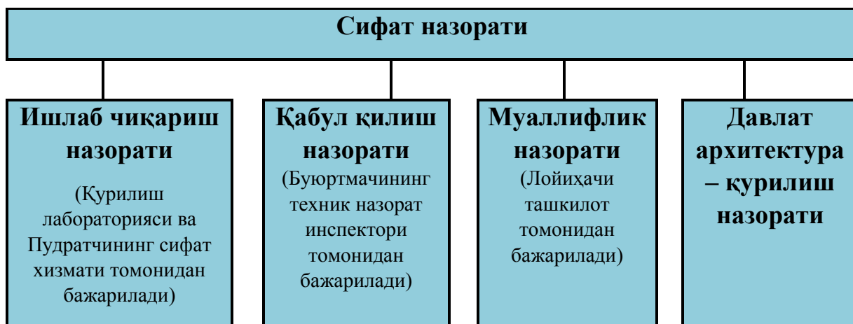
2.1-расм. Қурилиш – монтаж ишларининг сифатини назорат қилиш тизимининг ташкил этувчилари
