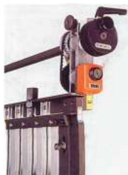
Расм 4. Таянчларни сонли индикаторда қўлда созлаш
