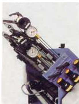
Расм 3. Таянчларни соатли индикаторда қўлда созлаш
